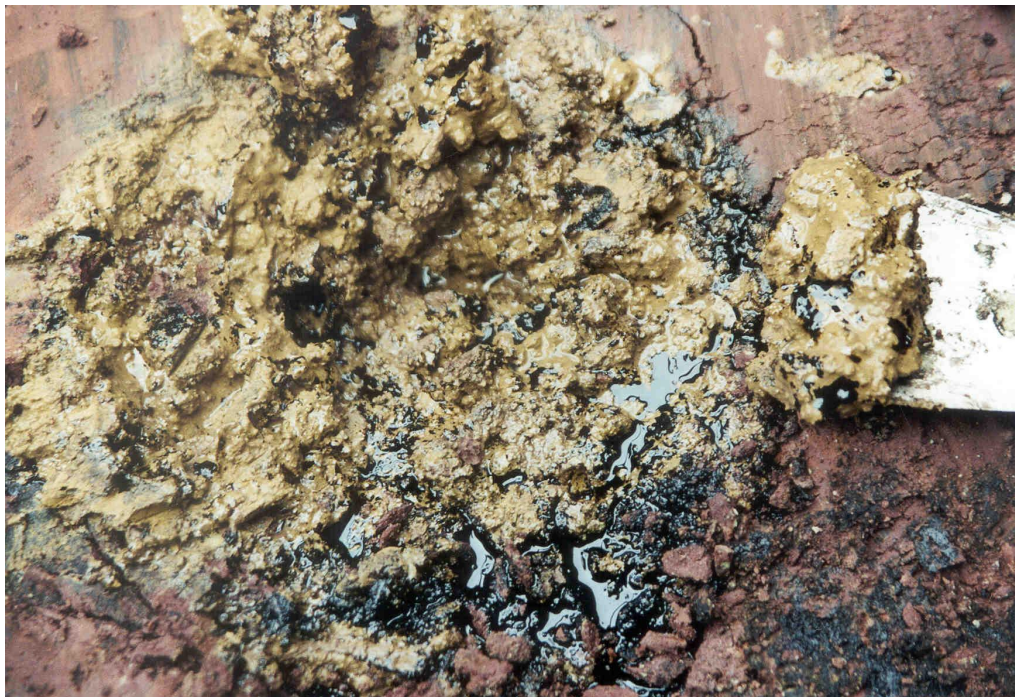
Abbildung 1: Unvollständig gequollene Tonpellets in Gegenwart von Teeröl in Phase
