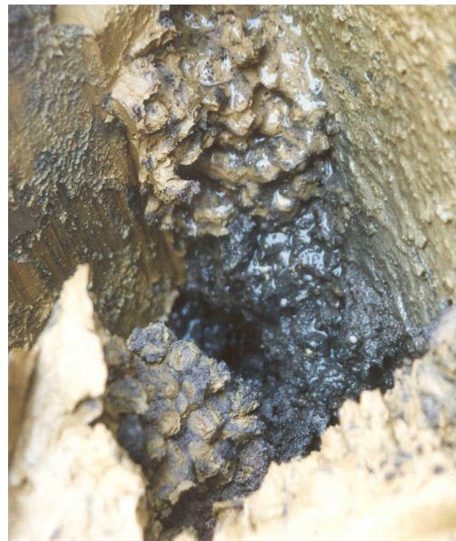
Abbildung 2: Nicht gequollene Pellets (links) und Teer-Coating (rechts)
