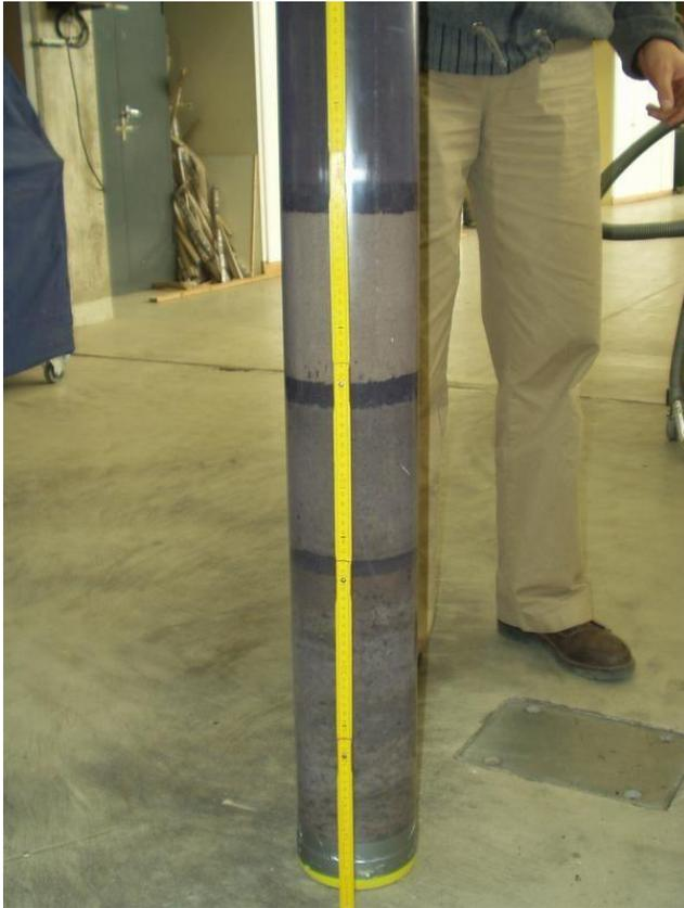
**Abbildung 1:** künstliche Bodensäule in transparentem Kunststoffrohr vor dem Einbau in den Container
